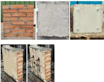
Figura 3. Fasi di realizzazione del muretto rinforzato con rete in fibre di canapa.
