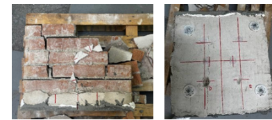
Figura 5 – Campioni non rinforzato (a) e rinforzato (b) a seguito della prova di compressione.
